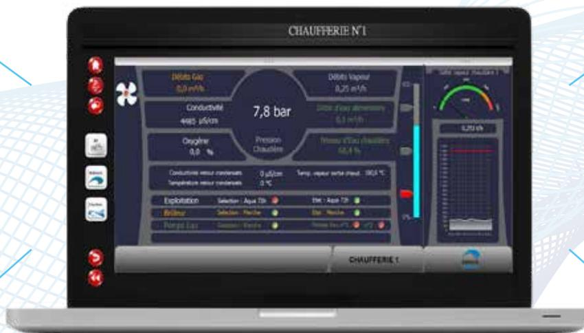
Nécessitant très peu de ressources, il s'installe sur tout PC équipé de Windows et communique avec des équipements, des automates, des bases de données. En réseau Ethernet, liaison série, protocoles Modbus RTU, Modbus TCP, etc.
